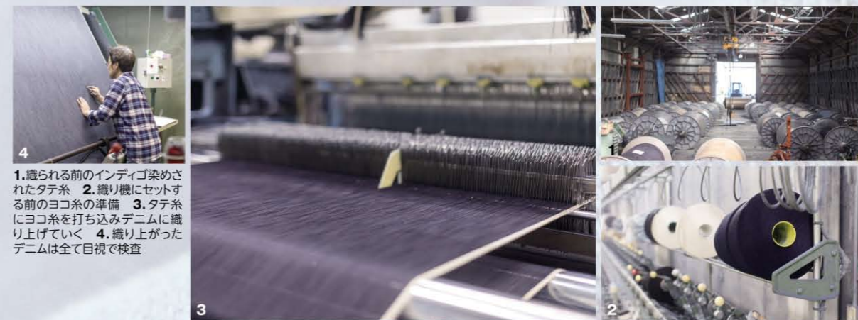
1.織られる前のインディゴ染めされたタテ糸 2.織り機にセットする前のヨコ糸の準備 3.タテ糸にヨコ糸を打ち込みデニムに織り上げていく 4.織り上がったデニムは全て目視で検査
